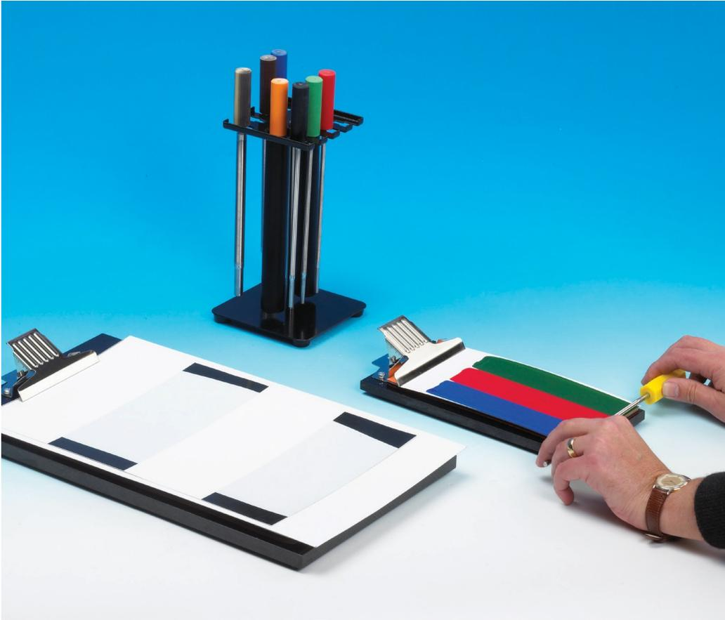
**Oben:** Small K Hand Coater mit Reinigungs-/Aufbewahrungsgestell; drei Flüssigtinten werden gleichzeitig aufgetragen. Ebenfalls abgebildet: Handbeschichtungsgerät Large K mit einer Kontrast-Testkarte.
