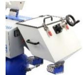
Felgenbeschussschrank **RIMpac II VDA** zur normgerechten Steinschlagprüfung nach VDA an ganzen Felgen bis 26" (Einhaltung des vorgegebenen Beschusswinkels von 54° in Verbindung mit dem korrekten Beschussabstand).
