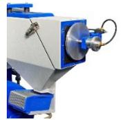
Umrüstsatz für Prüfungen nach **Daimler DBL 5416**, für senkrechten Beschuss unter 90°, bei stufenlos einstellbarem Beschussabstand.
